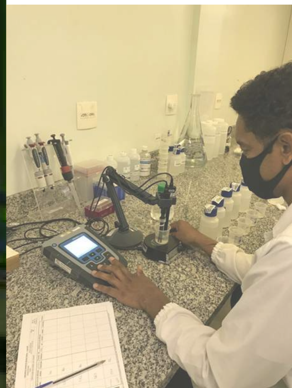
Foto 01 - Realização do ensaio de dosagem de fluoreto pelo método do eletrodo íon seletivo.
