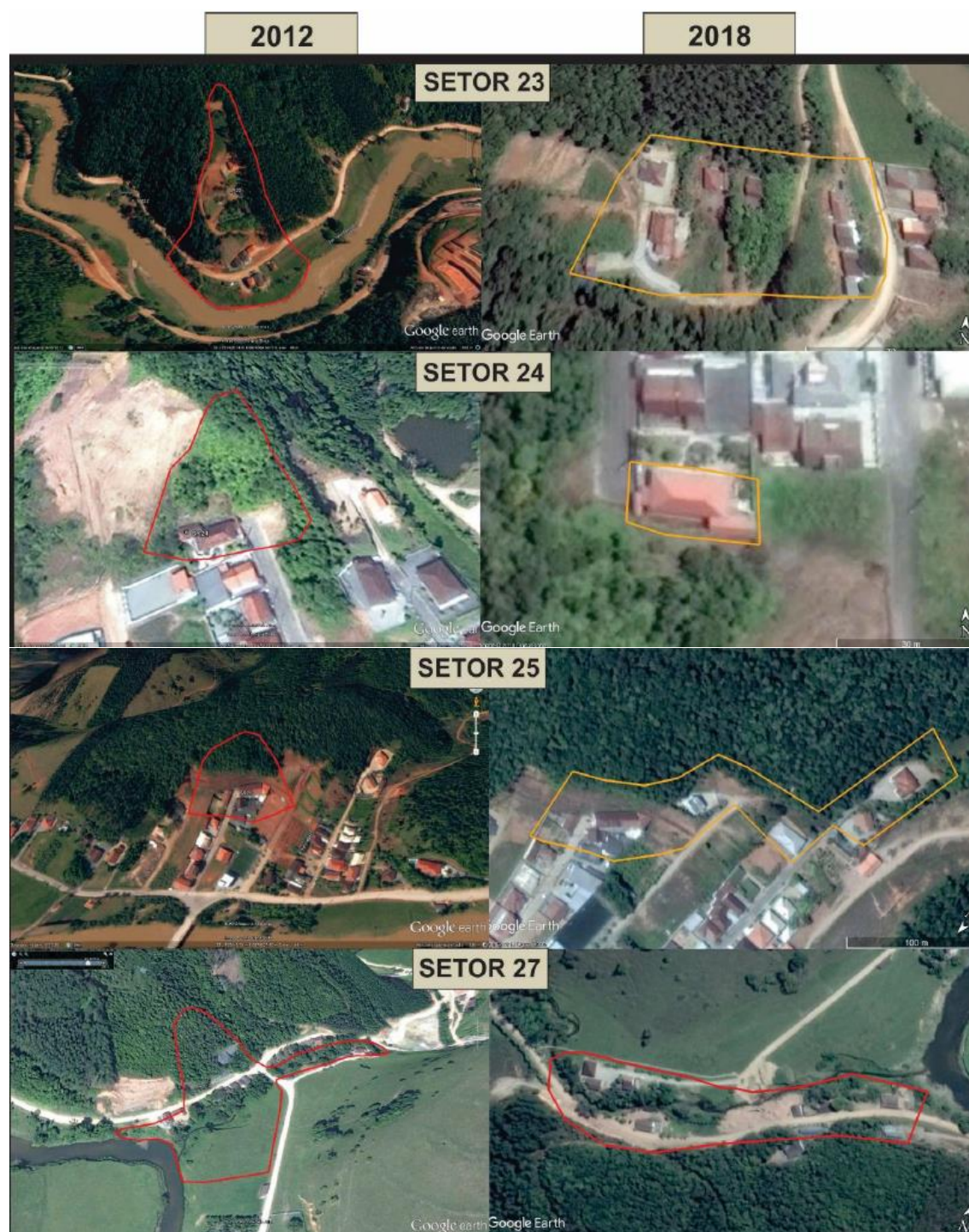
Figura 13: Delimitação dos setores de risco (setores 23 ao 27) realizada em 2012 (a esquerda) e em 2018 (a direita). Fonte: CPRM, 2018.
