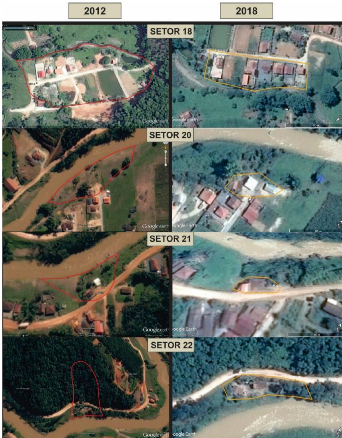
Figura 12: Delimitação dos setores de risco (setores 18 ao 22) realizada em 2012 (a esquerda) e em 2018 (a direita). Fonte: CPRM, 2018.
