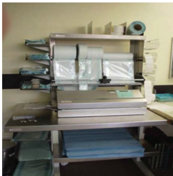
Figura 18. Exemplo de estação de trabalho de termosselagem
