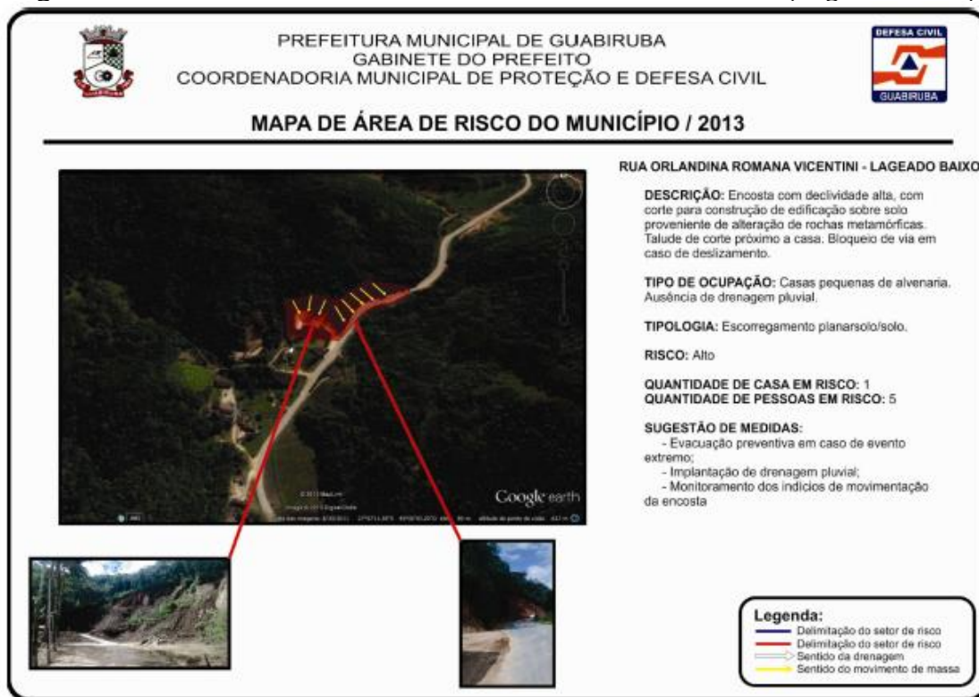
Figura 26 – Área de Risco nº22: Rua Orlandina Romana Vicentini (Lageado Baixo).
