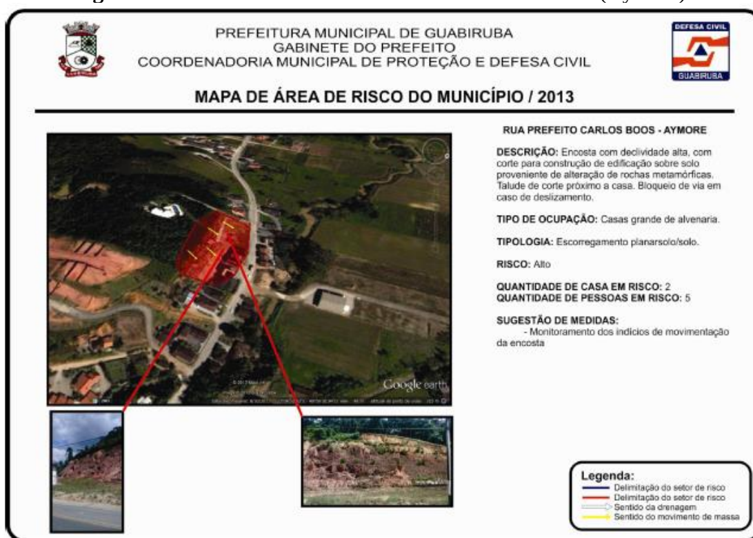
Figura 30 – Área de Risco nº26: Rua Prefeito Carlos Boos (Aymoré).
